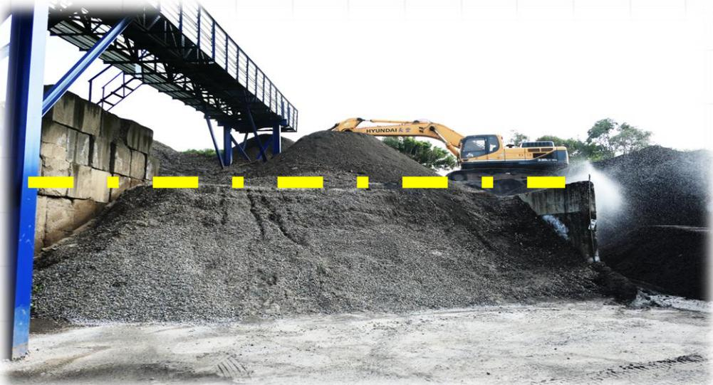
現場阻隔牆高度不足堆置物高1.25倍，空污費原申報防制措施為阻隔牆高於堆置物1.5倍，移除防制效率(75%修正為0%)，增加空污費費用
