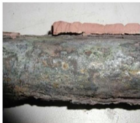
高氯含量燃料燃燒造管線之高溫腐蝕(Khan et al., 2009)
