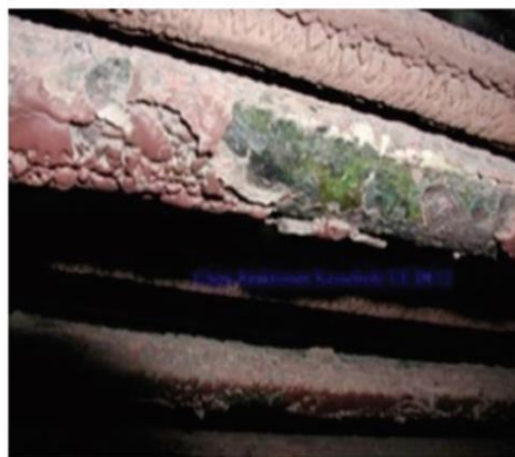
高氯含量燃料燃燒造管線之高溫腐蝕(Khan et al., 2009)
