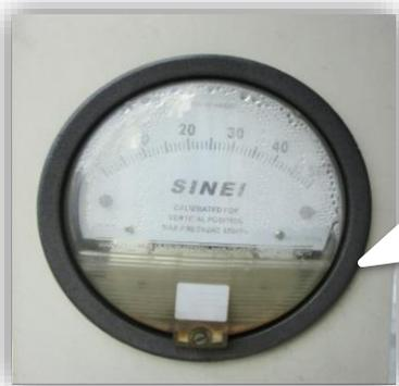
壓差計損壞(進水及指針斷裂)
